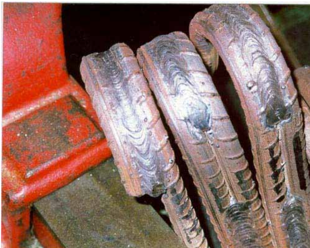
Amostras emendadas após ensaio de dobramento
