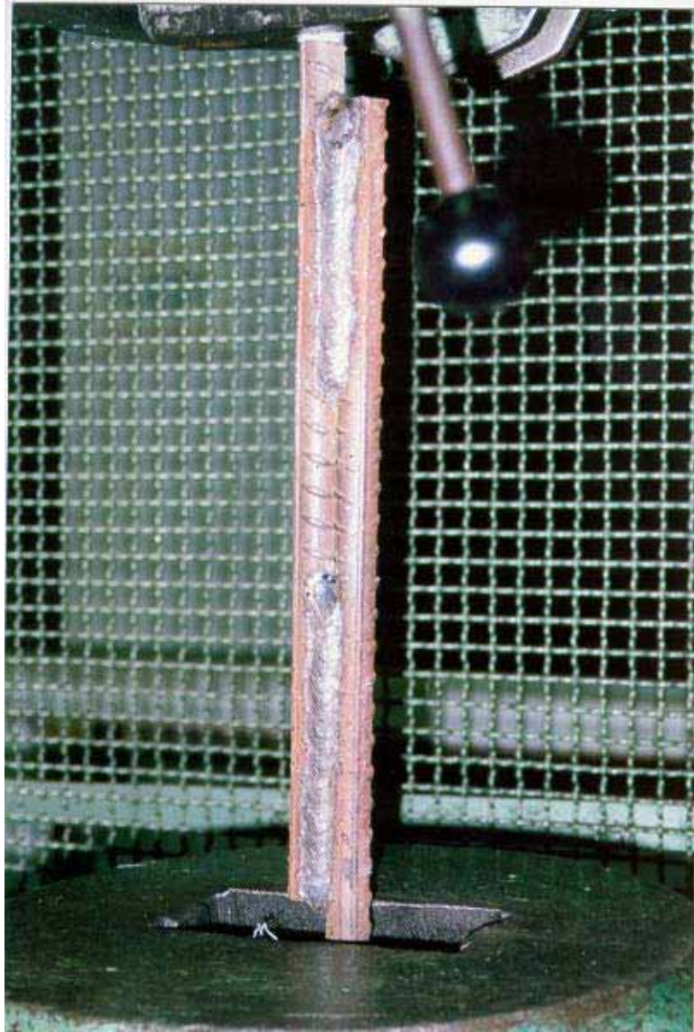
Corpo de prova na máquina universal para ensaio de tração
