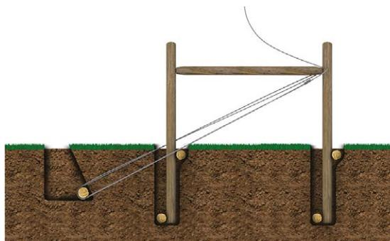
27. Reúna os arames no centro do palanque com o auxílio de uma torquês.
