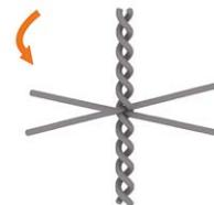
6. Instale o atilho entre os fios do Belgo AçoFix® na altura do fio do meio da cerca.
