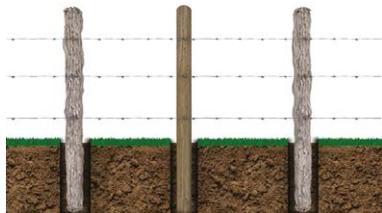
4. Repregar os fios de arame farpado soltos. Quando a madeira usada como mourão tiver casca grossa, for pouco densa ou rachar com facilidade, o procedimento será repetido constantemente.
