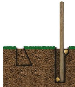
17. Prepare a peça de madeira que vai servir de "morto" ou âncora (20cm a 25cm de diâmetro e 1m de comprimento).
