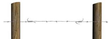
7. Nunca aplique os grampos sobre os fios da cerca, pressionando-os nos mourões. Esse procedimento evita que o arame corra dentro do grampo e danifique a estrutura do arame, criando pontos de enfraquecimento do fio.
