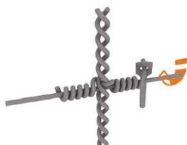
8. Com a ajuda do torcel, torça as duas pontas do atilho em volta do fio da cerca.
