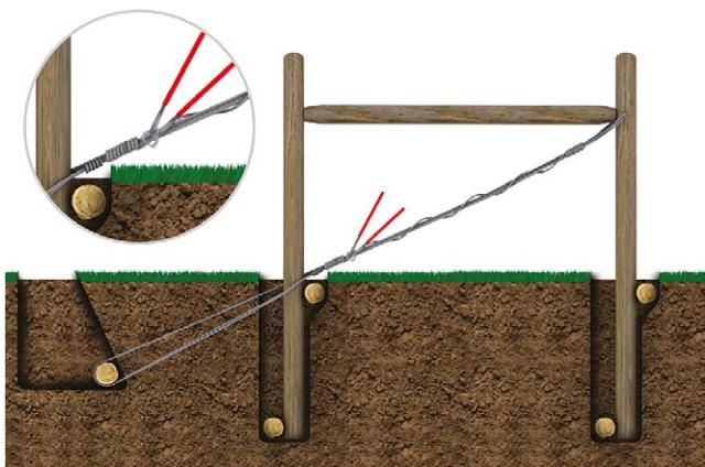
33. Verifique a tensão da rédea para que ela exerça uma força contrária ao sentido da cerca suficiente para auxiliar na ancoragem da cerca.
