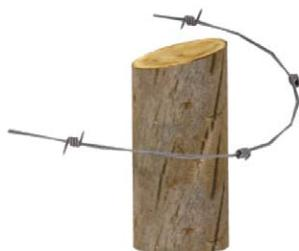
18. Arremate a ponta do arame com uma charrua (não é indicado o uso de grampos para fixar o arame no mourão esticador, porque essa prática danifica o arame e reduz a eficiência da cerca).
