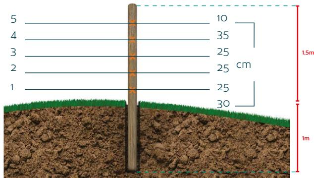
37. Faça os furos nos locais marcados para a passagem dos arames. É importante observar o alinhamento do sentido dos furos com o alinhamento da cerca. A parede dos furos pode exercer uma força de atrito no arame que pode dificultar a sua passagem e o seu esticamento.
