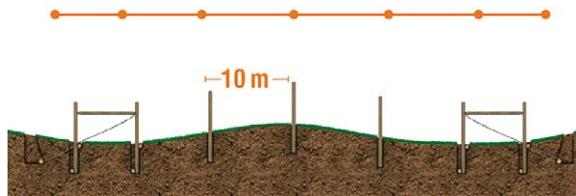
35. Faça um buraco de 70cm de profundidade e instale o poste intermediário, deixando-o com 1,5m para fora da terra.
