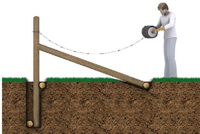
17. Usando a ponta solta do arame, faça duas voltas sob a marca da disposição do fio superior da cerca no mourão esticador.
