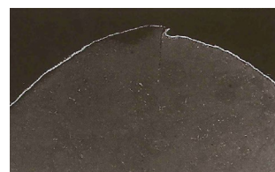
Bezinal® apresentando uma camada contínua de FeAl
