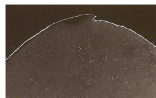
Bezinal® apresentando uma camada contínua de FeAl
